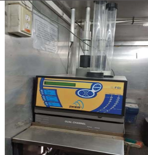
Vista interior del analizador de material particulado
