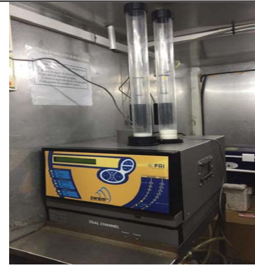
Vista interior del analizador de material particulado
