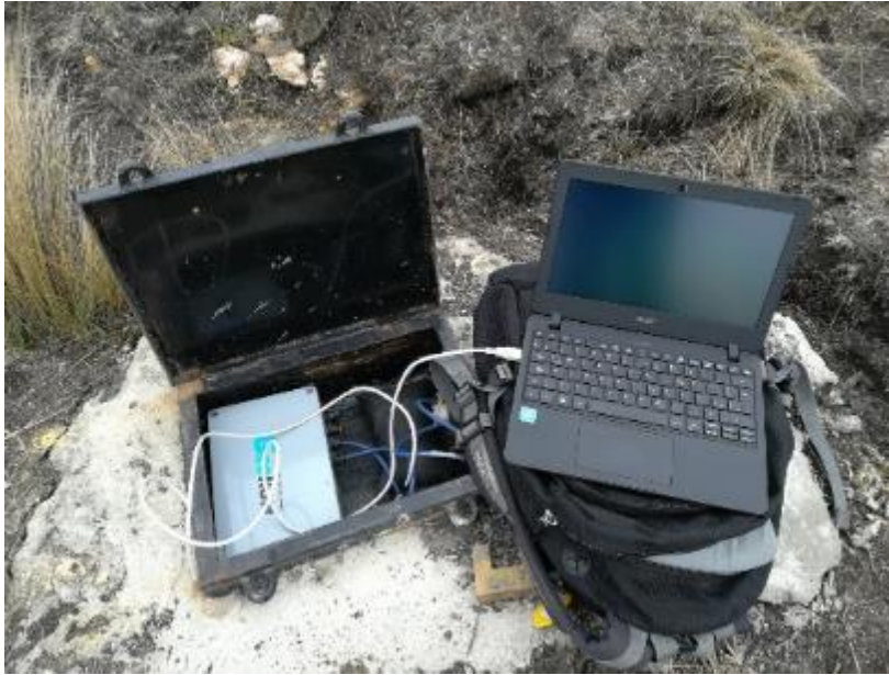
Figura 6-205 Descarga de datos mediante software de Geokon
