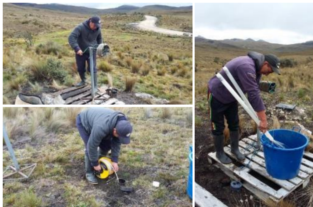
Figura 6-207 Toma de Muestras de Aguas Subterráneas en los Piezómetros de Monitoreo
