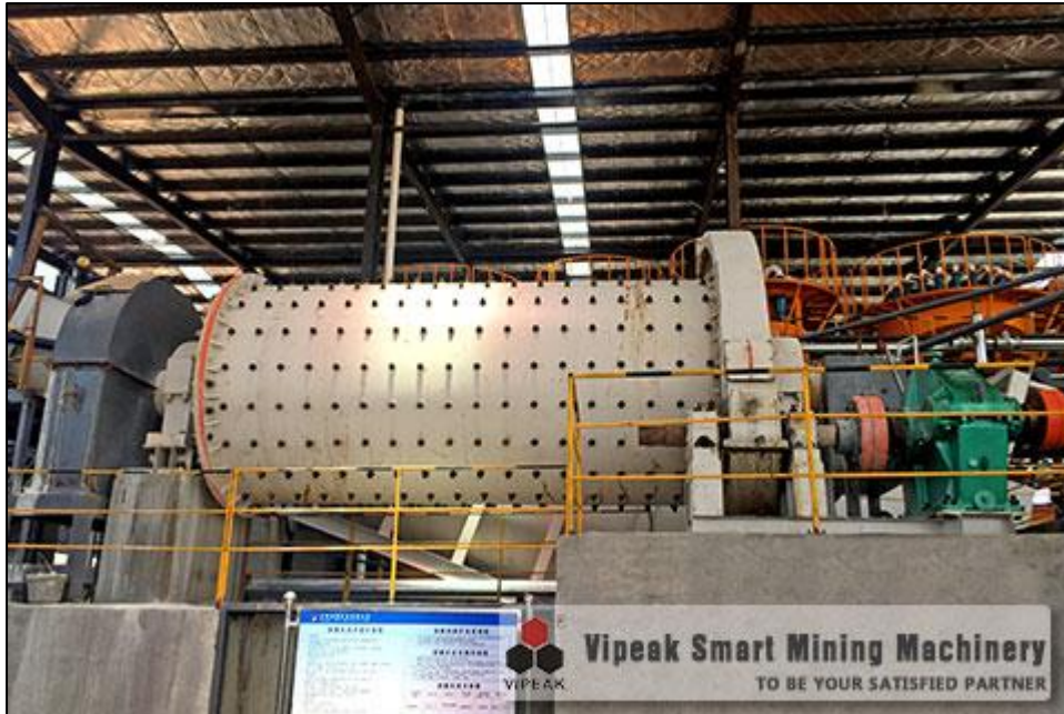
Figura 7-50 Ejemplo de un Molino de Bolas dentro de un Edificio Revestido con Lámina (vista interna)
