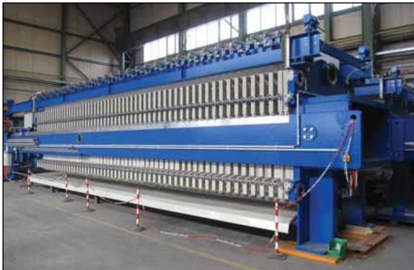
Figura 7-51 Ejemplo de Filtros dentro de un Edificio Revestido con Lámina
